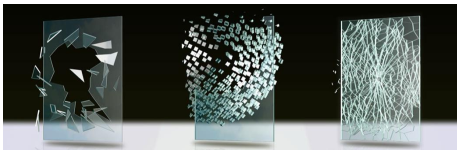
2 pav. Stiklo dužimo būdai (iš kairės į dešinę: paprastas, grūdintas, laminuotas stiklai)
